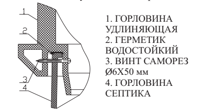
Рис 3. Монтаж удлиняющей горловины
